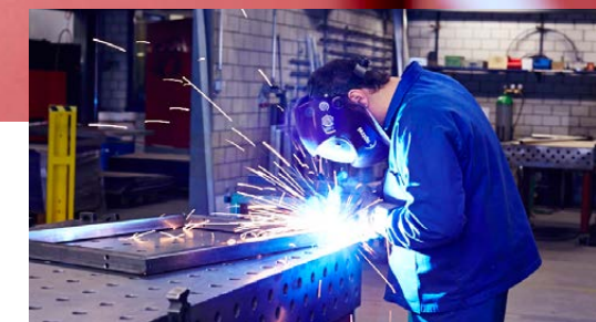
► Schweißen von Rohblech (Vorfabrikat)
